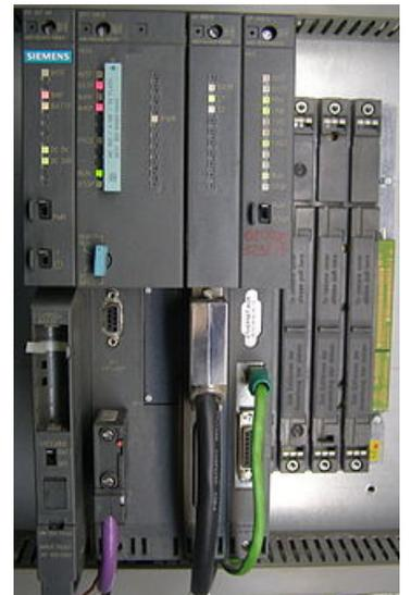
底板上的Siemens Simatic S7-400系統。從左到右分別是：電源供應單元（PSU）、CPU、介面模組（IM）及通訊模組（CP）
